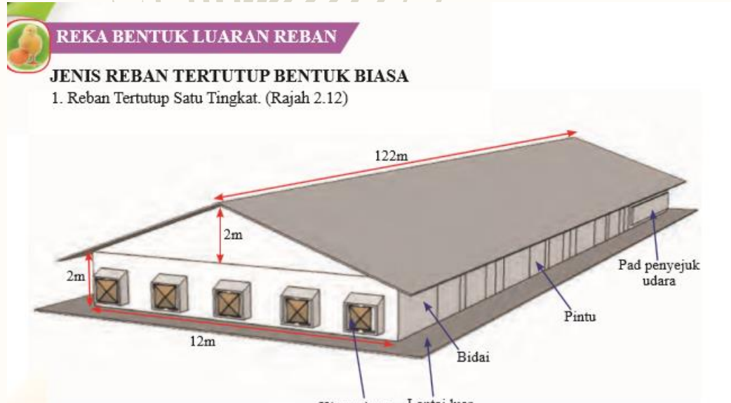
Rajah 2.12 Pelan lakar reban tertutup satu tingkat berlantai sarap
